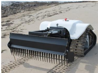
BeBot : robot des plages qui tamise le sable, collecte les déchets, nivèle les étendues de sable, joue de la musique et déplace de lourdes charges.
