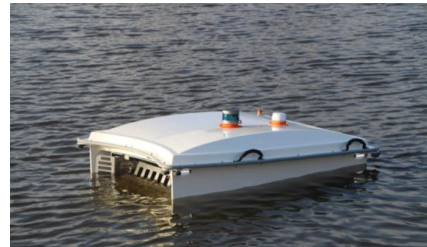
PixieDrone, drone flottant qui attrape les déchets, collecte des données et soutient les équipes de nettoyage au quotidien (en phase de test).
